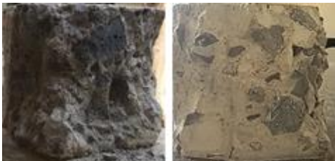
Hình 3.8. Mặt phá hoại của BTXT và DC
