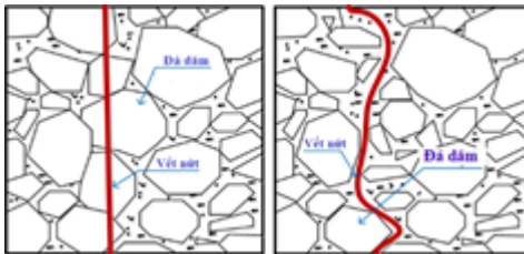
Hình 3.9. Các dạng phá hoại của bê tông dùng cốt liệu là đá tự nhiên
