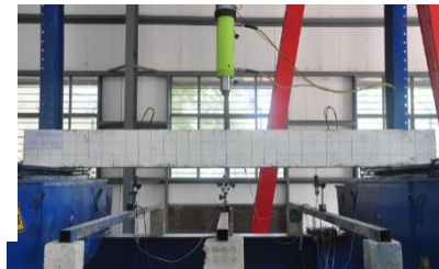
Hình 4.3 Thí nghiệm uốn 3 điểm với dầm BTCTXT
