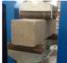
Hình 3.7. Thí nghiệm cường độ kéo khi uốn với sơ đồ uốn 4 điểm
